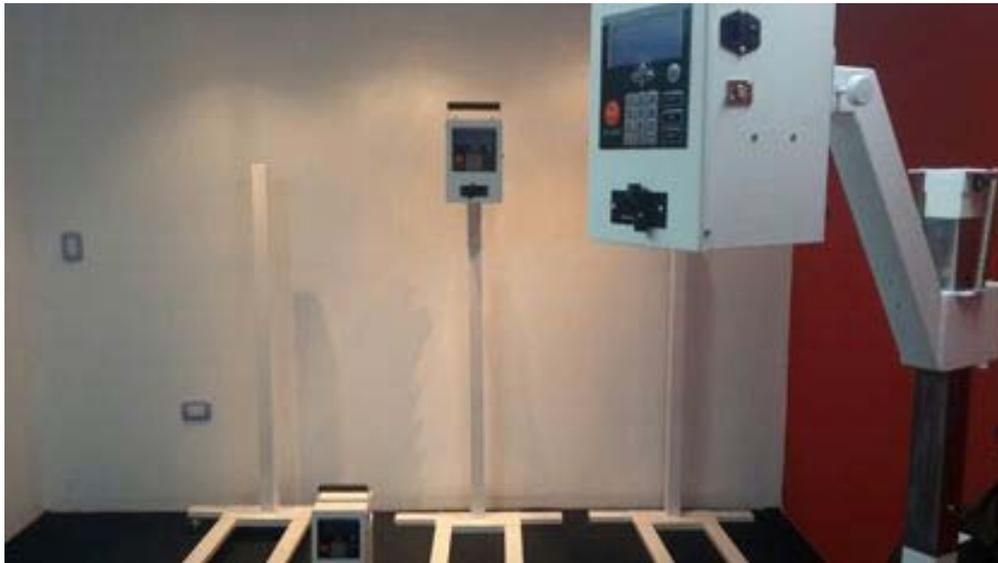
Este equipo está destinado para realizar radiografías en animales. Es una unidad de Rayos - X para uso veterinario, con tensión nominal de 70Kv, 80Kv, 90Kv y corriente al tubo de 45 mA. Posee un menú digital, el cual cuenta con tres formas de disparos, ya sea manual, automático o temporizador (timer).
