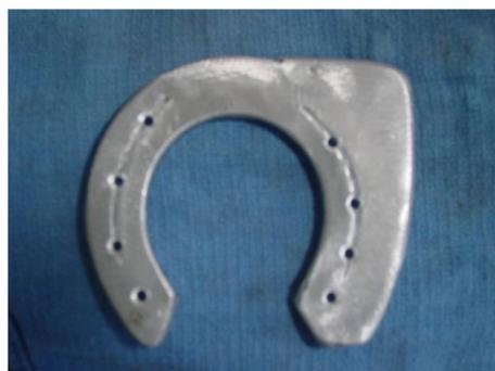
Fig. 6 a: Herradura con extensión confeccionada por el herrador.
